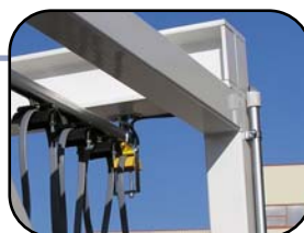
DETTAGLIO CARRELLI CAVI
